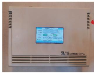
▲浮上の制御からエラーメッセージの表示まで作動に関する全てをコントロールしている制御盤。
