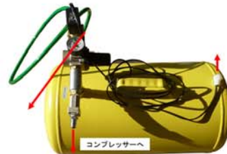
エアータンク（電磁バルブ・レギュレーター付）約40リットル
